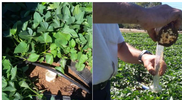
Figura 2. Recolha de água de um gotejador (à esquerda) e medição do respetivo volume (à direita).
