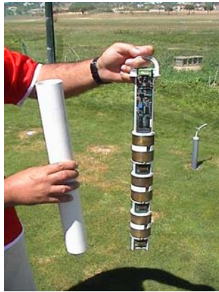
Figura 4 – Sonda EnviroSCAN com três sensores do teor de humidade do solo a três profundidades (5, 15 e 25 cm)
