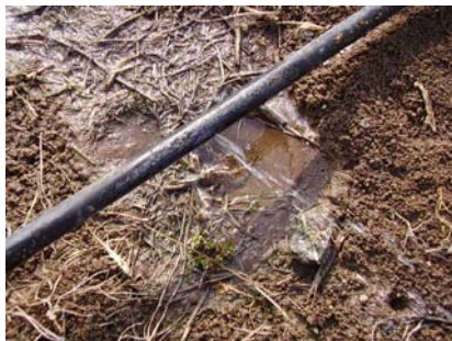
Figura 4 – Fugas detectadas nos laterais do sistema de rega
