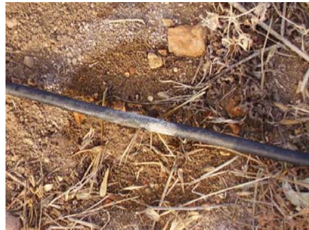
Figura 3 – Precipitado de cálcio no orifício de saída do gotejador
