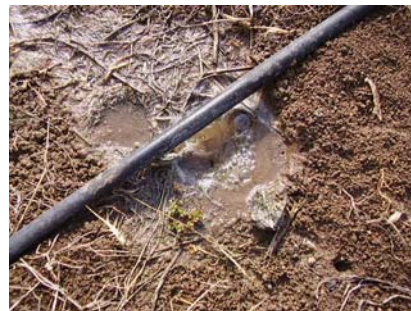
Figura 4 – Fugas detectadas nos laterais do sistema de rega
