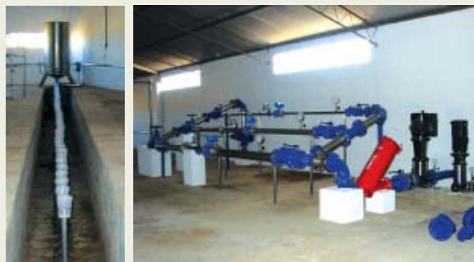
Figura 7 - Banco de Ensaio de Aspersores e Banco de Ensaio de válvulas, filtros e contadores
