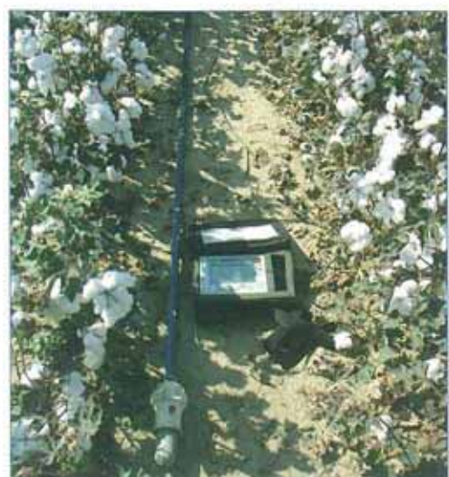
Figura 6 – Sonda de registo pontual "Diviner".
