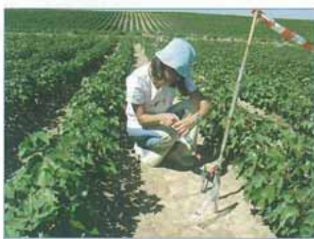
Figura 5 – Medição dos lisímetros de sucção.
